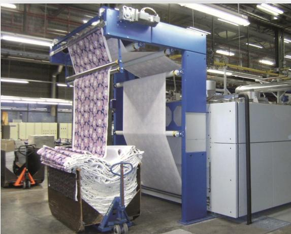
**THERMOCURE**热效烘干机在需要离线固色时可直接安装在印花机后道，也可安装在后整理线上作为洗涤后的最后一道烘干。
