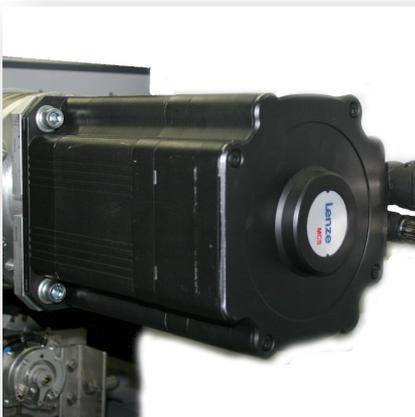
印花倒带伺服驱动与输送带指示系统相关联确保定位时间小于0.3秒，精度误差小于5微米（专利申请中）
