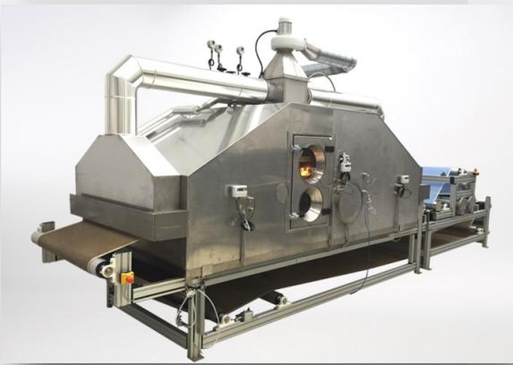
**SUPRAFIX SHS** 超级固色装置是一个组合型水平式的固色系统，可根据墨水用量来选择使用饱和蒸汽、过热蒸汽或热风。固色过程由蒸汽或热气流经管槽控制，确保在最短的时间内达到最大渗透、墨水固色和烘干一次性完成。**SUPRAFIX SHS**超级固色装置避免打印织物交由其它离线处理过程，从根本上减少能耗，同时整个过程更经济环保。
