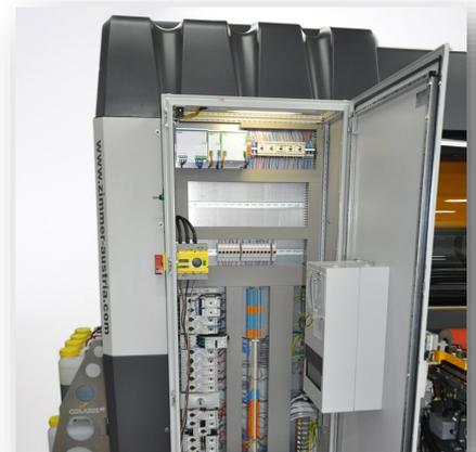
集成电控箱缩短安装时间，节约电线电缆，减少来自外部干扰的风险
